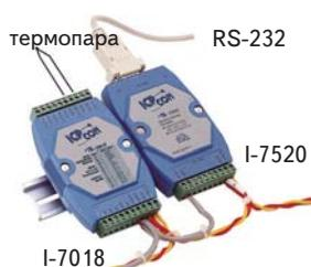
подключим один модуль АЦП для термопар i-7018 к коммуникационному порту компьютера. Модули сбора данных i-7000 имеют интерфейс RS-485, поэтому нам потребуется преобразователь интерфейса RS232/RS485, например, модуль i-7520. А ко входам первого канала **Vin1+** и **Vin1-** модуля i-7018 подключим термопару. И естественно следует обеспечить питание модулей - будем использовать источник +24В фирмы MeanWell DR45-24.
